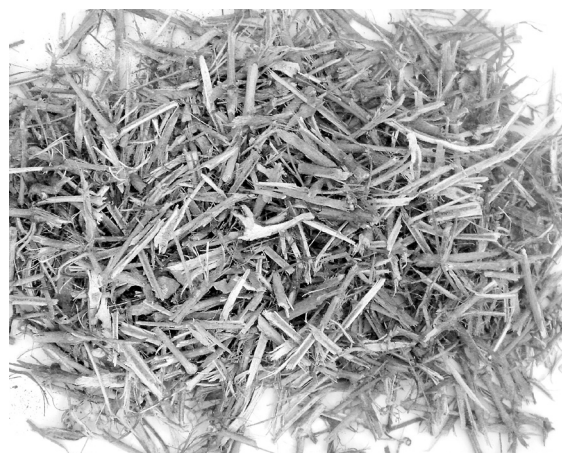
Рис. 2 Обрезки лозы после прохода измельчителя ИВ-1,5
