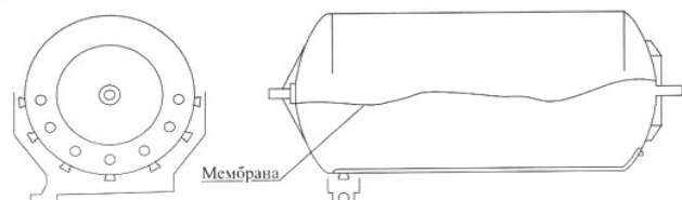
Рис.1. Схема прессы фирмы DIEMME.
