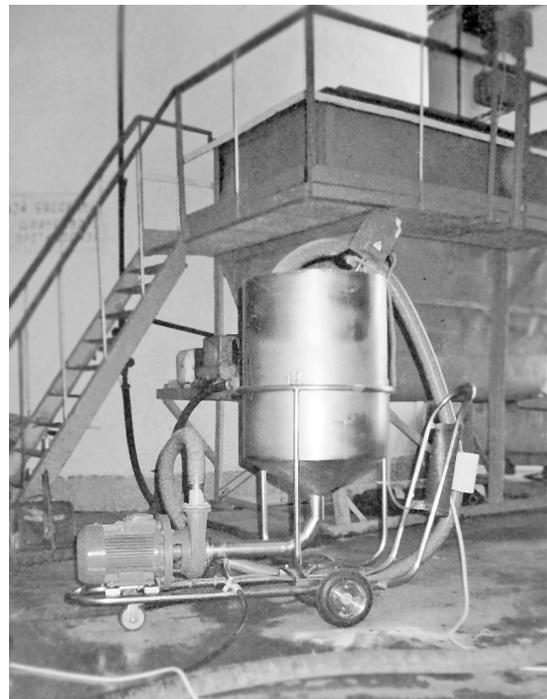
Рис. 3. Установка для приготовления суспензии бентонита марки УСБ-0,5
