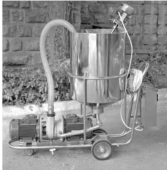
Рис.4. Установка кавитационной обработки дрожжевой массы для приготовления автолизатов дрожжей марки ВА-0,6
