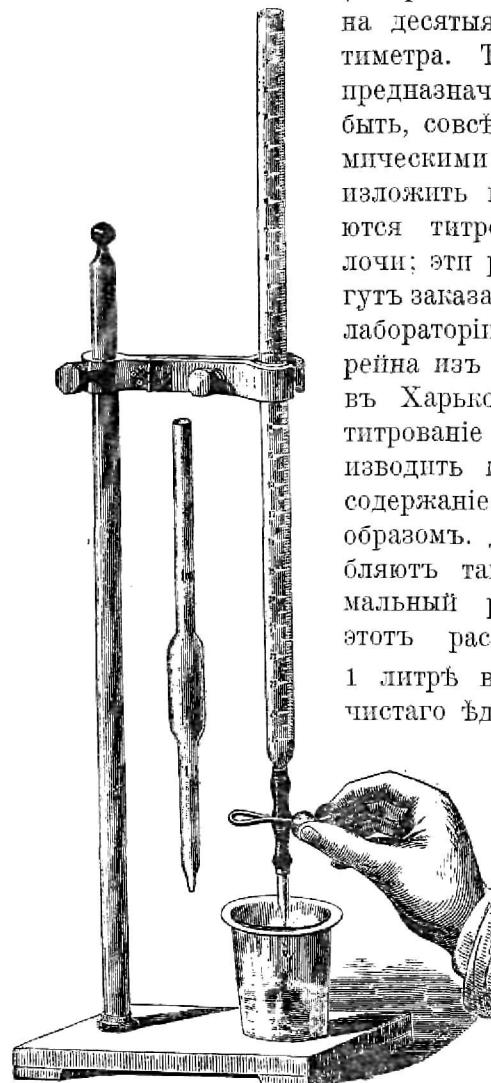
Рис. 21. Бюретка для опредѣленія кислотности вина.
