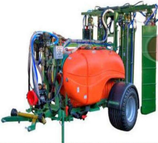
Общий вид двухрядного прицепного опрыскивателя Lipco GSG- NV-VM2
