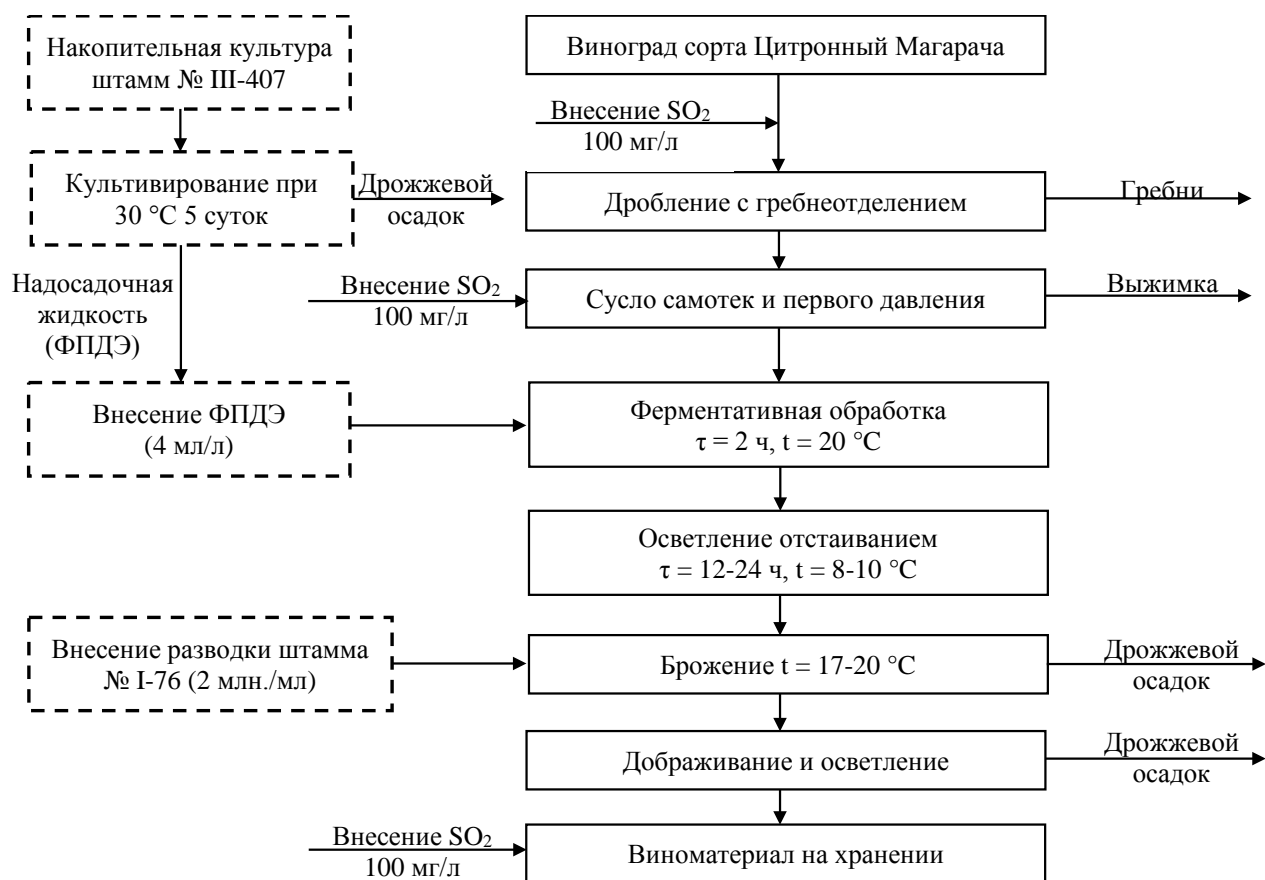
Рисунок 11 – Схема производства сортовых виноматериалов из винограда сорта Цитронный Магарача
