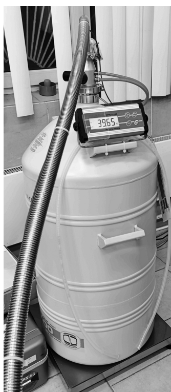
Рис. 3. Блок охлаждения для криодатчика для Bruker Ascend™ 700
