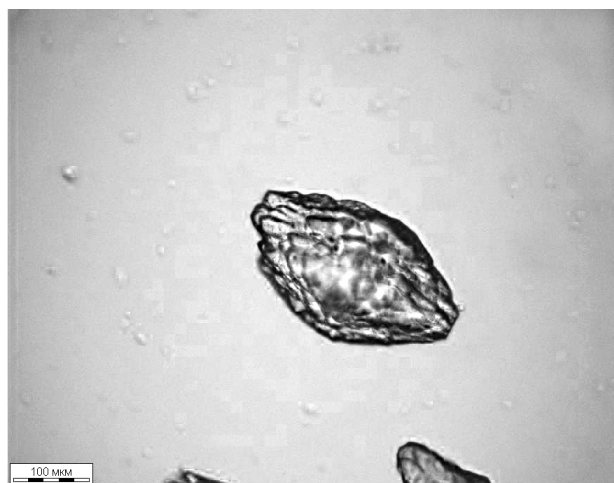
Рис. 5. Крупный непрозрачный кристалл, утративший строгую ромбовидную форму Fig. 5. Big opaque crystal, lost strict diamond shape
