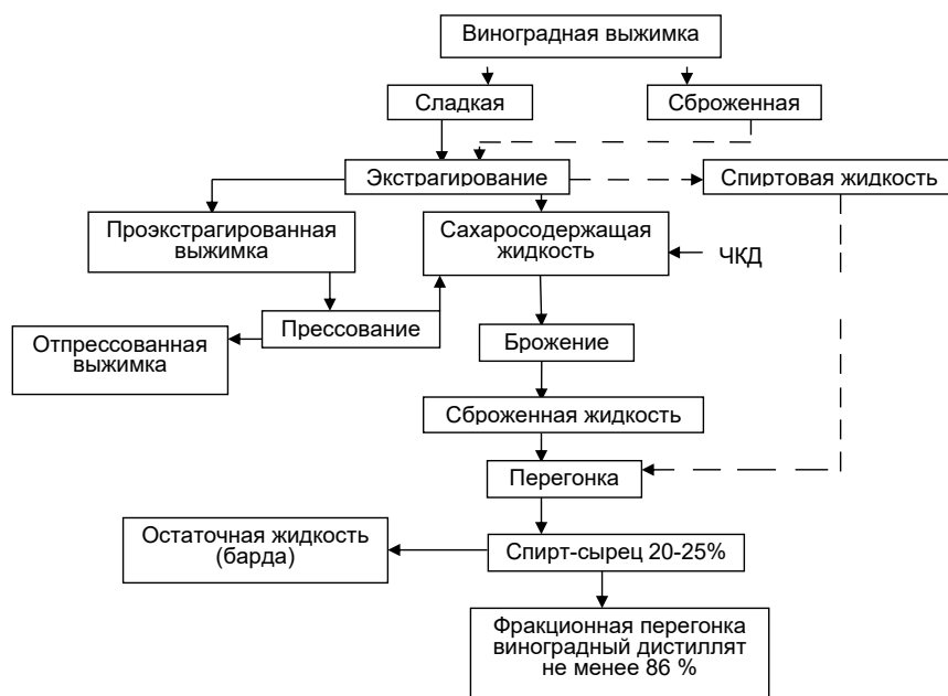
Рис. 1. Технологическая схема получения виноградных дистиллятов
