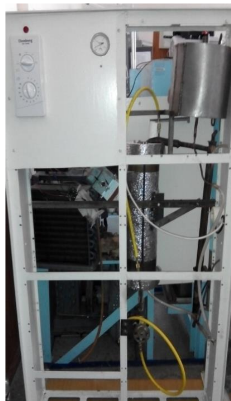
Рисунок 27 – Фото пилотной установки СВЧ вакуум-выпарной установки
