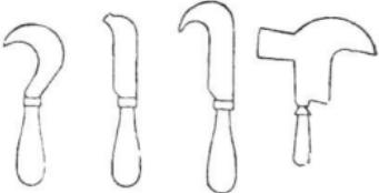
Рис. 149. Ножи для обрезки. (Ориг.).
